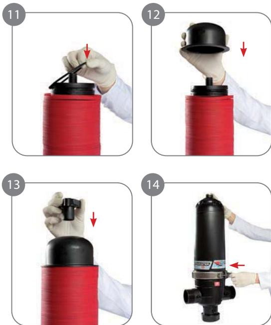
Убедитесь, что система не находится под давлением! Откройте фильтр и извлеките дисковый картридж. Отвинтите верхнюю гайку картриджа, снимите крышку поршня и снимите диски с оси картриджа.
