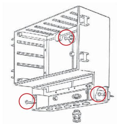
Для установки нижних винтов, нужно сперва снять защитную крышку для проводов:
