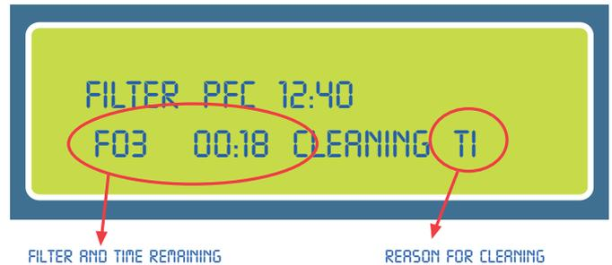
В данном примере идет прочистка фильтра 3. До начала прочистки следующего фильтра осталось 18 секунд. Также указано, что процесс очистки задан по параметру времени (таймер, TI).
