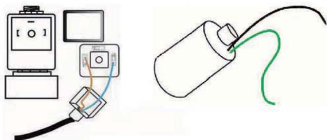
Обратная полярность заслоночных соленоидов изменяет их работу и последовательность работы проводов (зависит от производителя). Например, режим работы изменится с «нормального закрытия» на «нормальное открытие».
