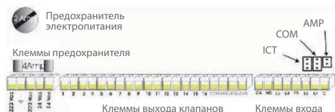
Подсоедините все электрические провода к внешним устройствам контроля или от внешних устройств подачи информации к контроллеру.
