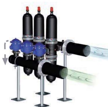
В нашем ассортименте имеются диски разных цветов и кодов, соответствующие разной степени фильтрации взвешенных частиц входящей жидкости. Автоматические станции фильтрации разработаны для разных режимов фильтрации. Ось картриджа оснащена внутренней поршневой пружиной для сжатия или извлечения дисков в течение процессов фильтрации и обратного хода.
