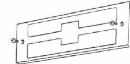
Можно снять защитную крышку, используя крючки и защелки.
