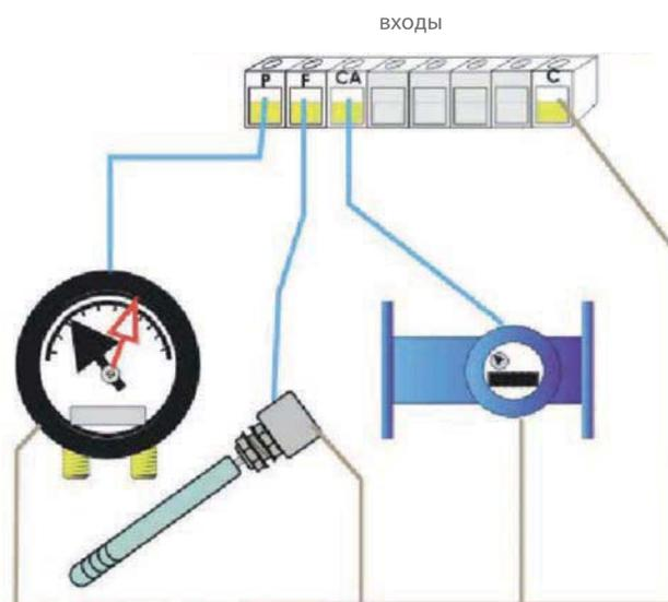
Мы видим схему подключения водомера и дифференциального манометра. Эти клеммы определены для этих устройств.
