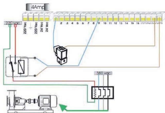
Вышеуказанная схема применима к автоматизации водяных помп, мешалок и электронасосов для впрыска удобр.
