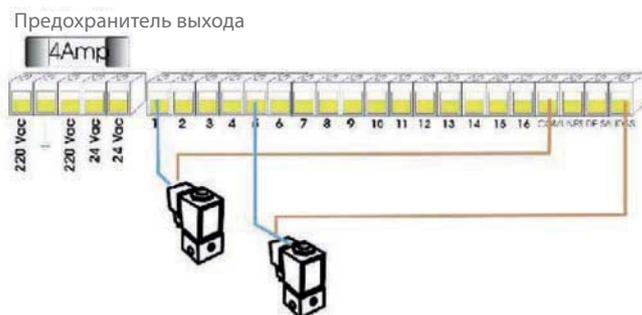
В схеме предусмотрены 4 общие клеммы (соединенные параллельно).
