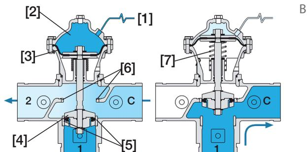
режиме прочистки: гидравлический блок управления (1) заполняет верхнюю камеру (2) жидкостью, что направляет диафрагму (3) в нижнем направлении; шток (4) движется вниз, Уплотнитель (5) перекрывает проток воды. Загрязненная вода поступает из фильтра в дренаж через сёдла дренажа (6).
