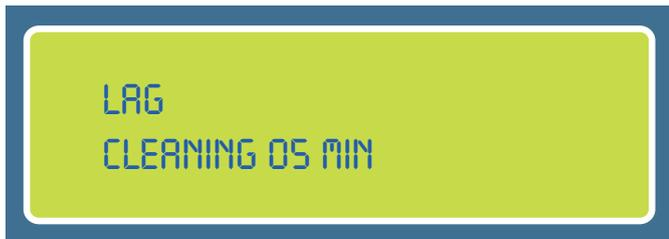
Определим время (в минутах) ожидания прочистки после указания периода активности (либо интервал времени, либо указание разрешения) и время простоя после каждого этапа прочистки.
