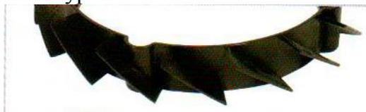
Эта турбина не вращается. Она установлена стационарно, а вода проходя через ее лопасти получает вращательное движение внутри фильтра. Таким образом все тяжелые частицы в воде не попадают в картридж, а оседают на корпус фильтра. Если фильтр установить вниз дренажным отверстием с краном, то периодически можно сливать через кран скопившуюся в корпусе грязь.
