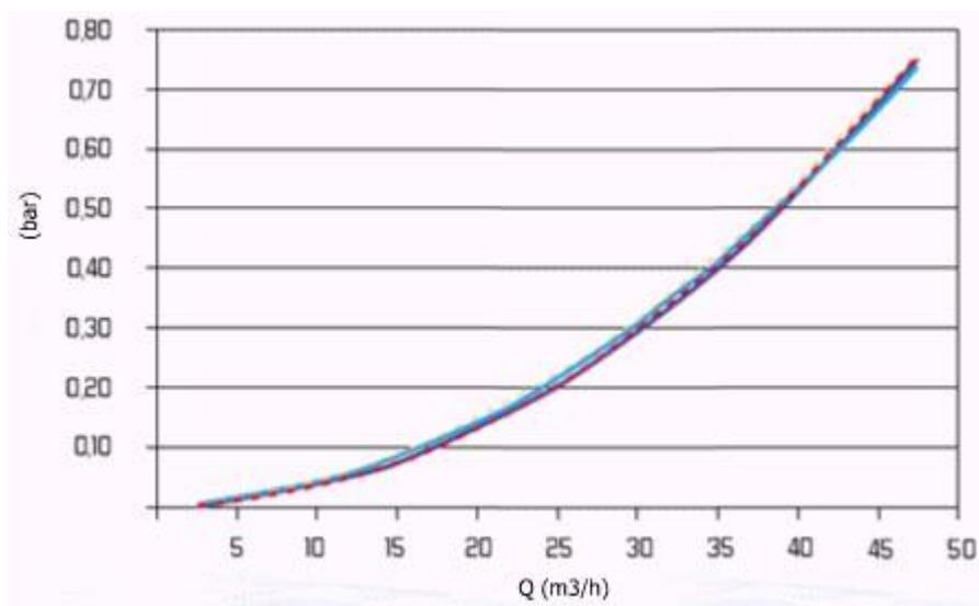
Рис. – Потеря давления при фильтрации для дисковых фильтров 2"
