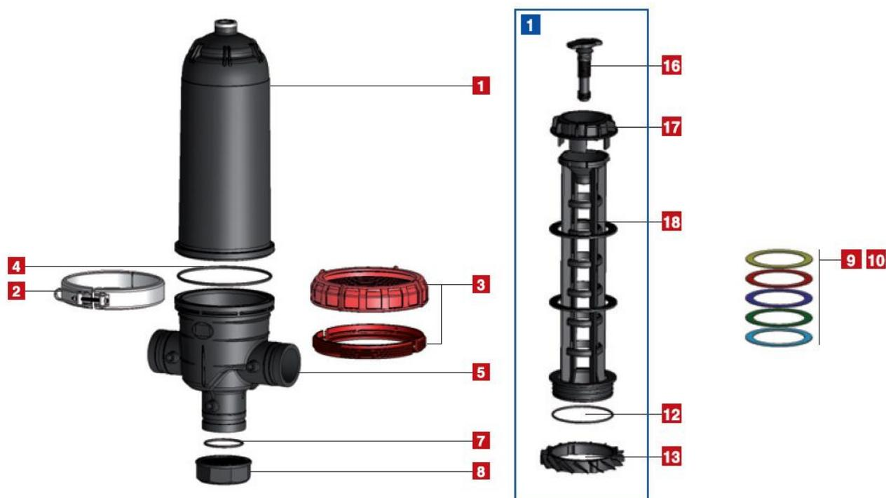
Узел держателя дисков специально спроектирован для сжатия фильтрующего элемента, собранного из кольцевых дисков. Таки образом во время фильтрации воде остается единственный путь между канавками в смежных дисках. На этом пути происходит захватывание твердых частиц из потока воды.
