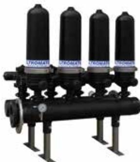
Устройство представляет собой фильтр с автоматической очисткой, который обеспечивает промывку фильтрующих элементов одновременно с подачей фильтрованной воды. Система выполняет запрограммированные операции очистки фильтрующего элемента, пока оставшиеся узлы продолжают фильтровать воду.
