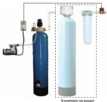
Блок аэрации предназначен для насыщения обрабатываемой воды кислородом воздуха с целью окисления содержащегося в ней растворенного железа. Может быть использован перед фильтрами с каталитическими загрузками (Birm, Pyrolox и т.п.).
