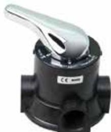
Трехцикловый адаптер М-77 предназначен для ручного переключения режимов работы засыпных фильтров (осадочных, угольных и т.п.). Возможные режимы: рабочий режим, обратная промывка, прямая отмывка. Рабочие элементы изготовлены из полированных керамических пластин, которые отличаются высокой твердостью (HRA>85) и параллельностью поверхностей (отклонение от плоскопараллельности < 0,3 мкм).
