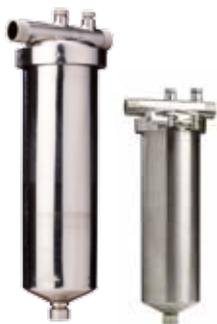
Корпус фильтра состоит из основания и крышки, соединённых между собой хомутом. Герметизация осуществляется круглым кольцом, уложенным в канавку фланца крышки, входной и выходной патрубков расположены в её верхней части.
