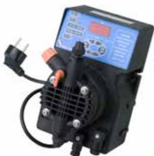
Насосы DLX — соленоидные цифровые дозирующие насосы пропорционального действия с микропроцессорным управлением. Насосы выполнены в антикислотном исполнении, панель управления защищена плёнкой от УФ-излучения. Стандартная высота забора реагента – 2 метра. Материал головки – полипропилен, мембраны – тефлон, прокладки мембраны, фиксирующих клапанов, прокладок клапанов – витон. Крепление – настенное. Класс защиты: IP65. Размеры: 190x120x150 мм. Максимальная частота – 120 тактов / мин.
