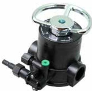
Пятицикловый адаптер М-77 предназначен для ручного переключения режимов работы засыпных фильтров, промывка которых осуществляется с участием химических реагентов (умягчители, фильтры Aquachief, фильтры с MGS и т.п.). Возможные режимы: рабочий режим, обратная промывка, регенерация с участием химического реагента, прямая отмывка, наполнение реагентного бака. Рабочие элементы изготовлены из полированных керамических пластин.
