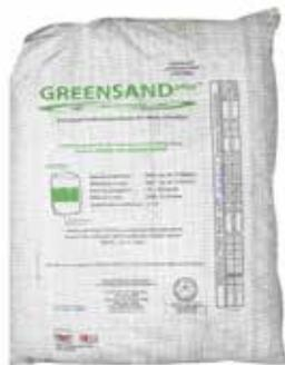
**GreensandPlus** – фильтрующая загрузка для удаления растворенных в воде железа, марганца и сероводорода. Диоксид марганца, которым покрыты гранулы загрузки, способствует реакции окисления указанных загрязнителей. Поскольку основой гранул GreensandPlus является кварцевый песок, материал хорошо работает на воде с низкой жесткостью, TDS и невысоким содержанием кремния.
