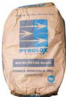
**Pyrolox** — гранулированная загрузка для удаления железа, марганца и сероводорода, рудный материал на основе диоксида марганца. Используется в процессе очистки воды уже около 100 лет. Pyrolox действует по следующему принципу: сероводород, железо и марганец окисляются, задерживаются слоем загрузки, а затем вымываются из неё при обратной промывке.
