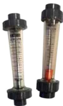
Ротаметр предназначен для измерения объемного расхода потоков жидкостей.
