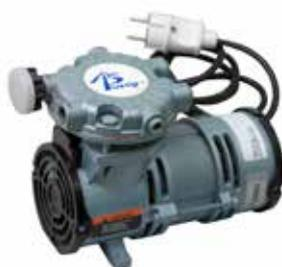
Компрессор AP-2 предназначен для подачи воздуха в системах аэрации воды. Снабжен тепловым предохранением от перегрузок, отключающим его электродвигатель. Компрессор имеет электрические выводы для подключения внешнего управляющего устройства (например, реле).
